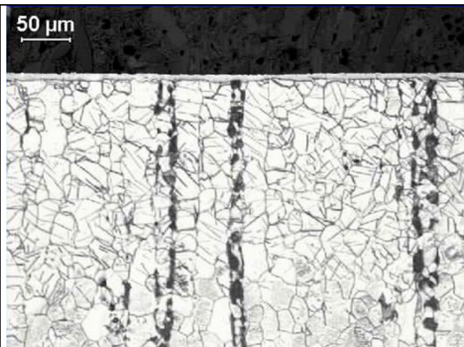
Foto 12 – 200 x in origine – strato composti e zona di diffusione del S355JR – ciclo 2
